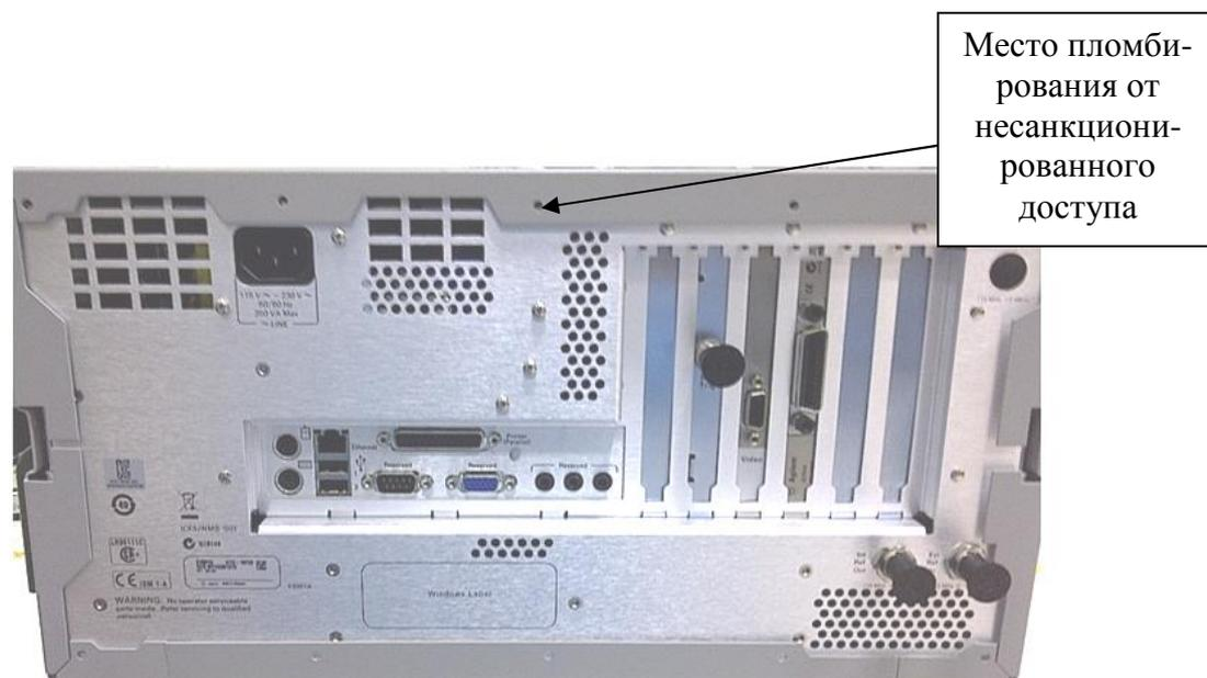
Рисунок 2 - Место пломбирования от несанкционированного доступа
