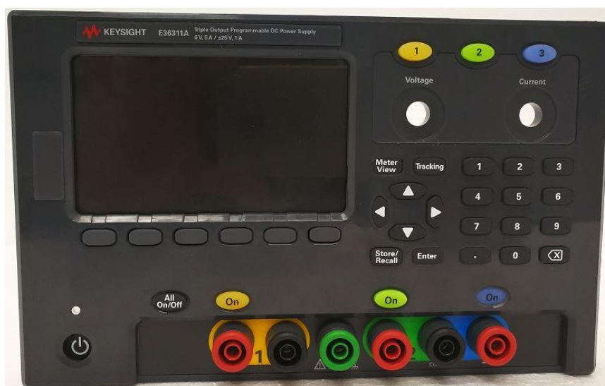
Рисунок 3 – Общий вид передней панели источников питания модификации E36311A с опцией RBP
