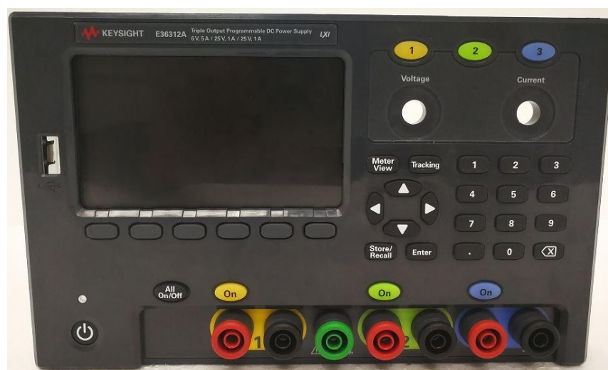
Рисунок 4 – Общий вид передней панели источников питания модификаций E36312A, E36313A с опцией RBP
