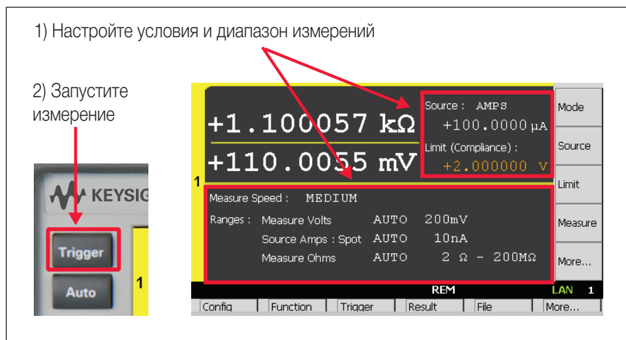
Рис. 5. Графический интерфейс пользователя источника/измерителя серии B2900A облегчает выполнение быстрых измерений
