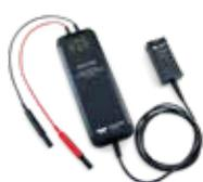
Серия высоковольтных диф. пробников HVD3000A, которые обеспечивают измерения напряжений в цепях, не имеющих общей точки. Идеально подходят для безопасных и простых измерений электрической мощности в различной силовой электронике. Благодаря высокому коэф. ослабления синфазных помех (CMRR) в сочетании с низким уровнем собственного шума и большим диапазоном смещения пробники HVD3000A наиболее оптимальны для анализа сигналов малых уровней в однофазных и 3-х фазных цепях.
