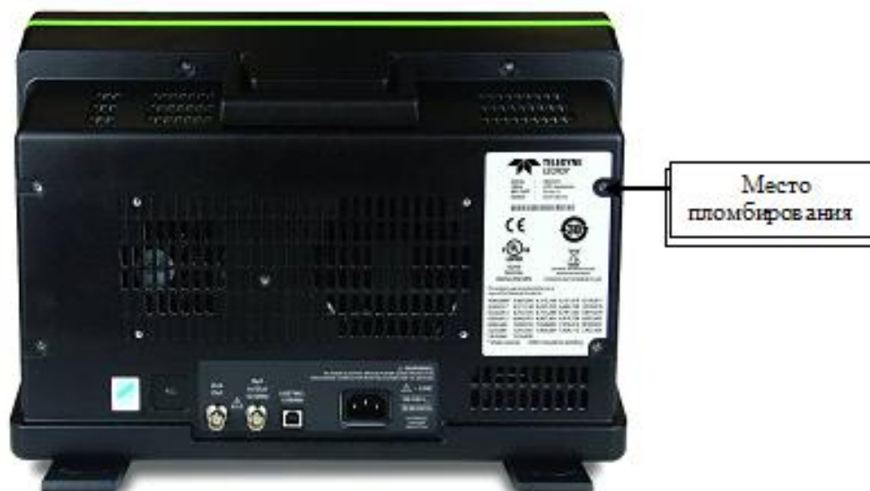
Рисунок 2. Схема пломбировки от несанкционированного доступа
