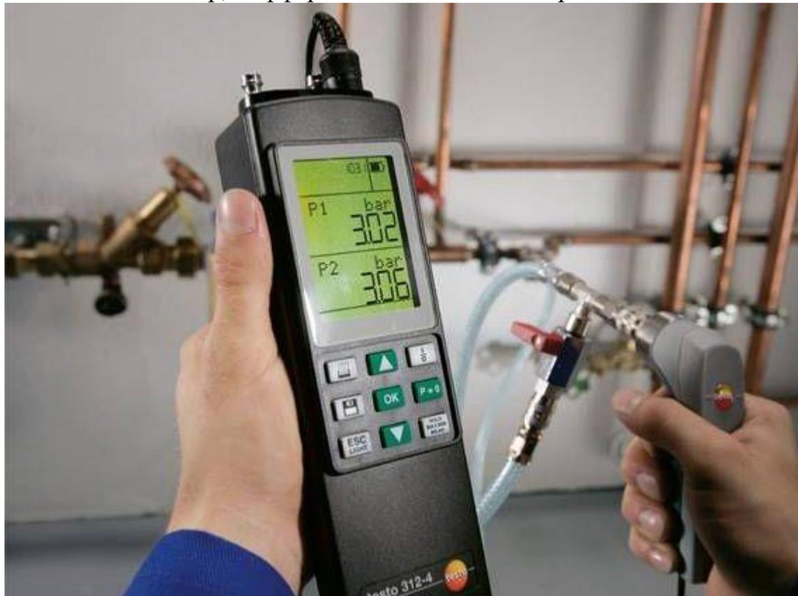
**Testo 312 дифференциальный манометр, технические характеристики**
