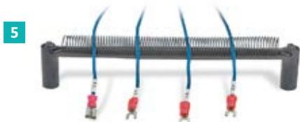
Поддерживают кабельные жгуты при их компоновке на столе СР-ЖГ. Держатели устанавливаются на магнитные пластины трех типов, что позволяет располагать жгуты на рабочей поверхности в нужном оператору положении.
