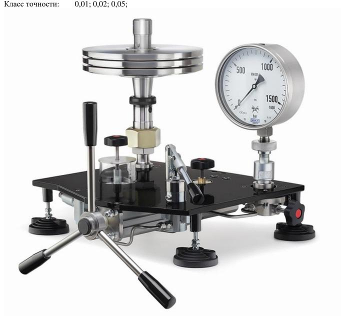
Грузопоршневой манометр МП-2500 предназначен для поверки и калибровки средств измерения избыточного давления: калибраторов давления, измерительных преобразователей давления (датчиков), образцовых и технических манометров, грузопоршневых манометров.
