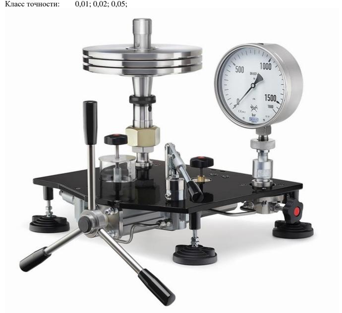
Грузопоршневой манометр МП-1600 предназначен для поверки и калибровки средств измерения избыточного давления: калибраторов давления, измерительных преобразователей давления (датчиков), образцовых и технических манометров, грузопоршневых манометров.
