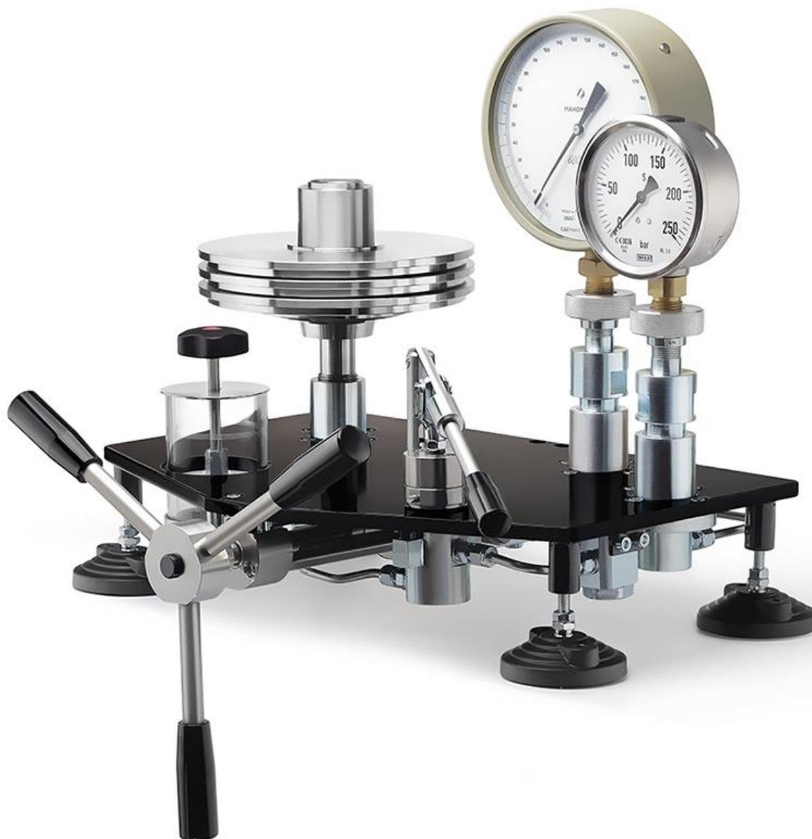
Грузопоршневой манометр МП-6 предназначен для поверки и калибровки средств измерения избыточного давления: калибраторов давления, измерительных преобразователей давления (датчиков), образцовых и технических манометров, грузопоршневых манометров. Измерительная поршневая система из карбида вольфрама для значительного снижения (в 4 раза) влияния температуры на результаты измерений, долговременной стабильности, износостойкости и долговечности прибора.
