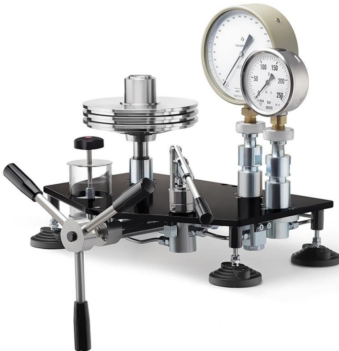
Грузопоршневой манометр МП-100 предназначен для поверки и калибровки средств измерения избыточного давления: калибраторов давления, измерительных преобразователей давления (датчиков), образцовых и технических манометров, грузопоршневых манометров.
