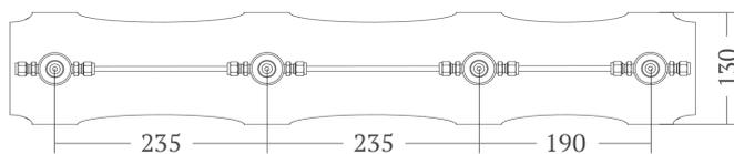
\* В стандартную поставку входит коллектор на 4 стойки для установки 1 эталонного СИ и до трёх поверяемых. По заказу возможна поставка коллекторов с иным количеством стоек.
