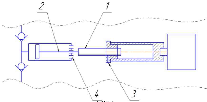
8.3.4 С помощью подходящего шприца вдавите смазку в отверстия 3 гаек ШВП;
