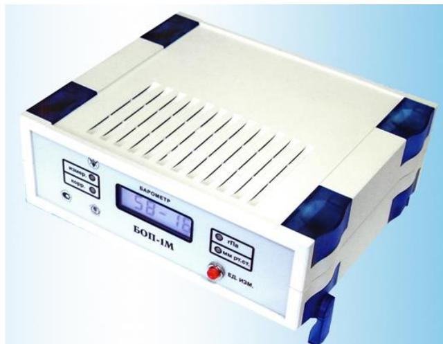
давления и датчика температуры поступают в частотный преобразователь, который из этих частот формирует цифровые значения, передаваемые в микроконтроллер. Микроконтроллер вычисляет значение измеренного давления, опираясь на индивидуальные градуировочные характеристики датчика давления и температуры, которые хранятся в ПЗУ микроконтроллера в виде коэффициентов аппроксимации.
