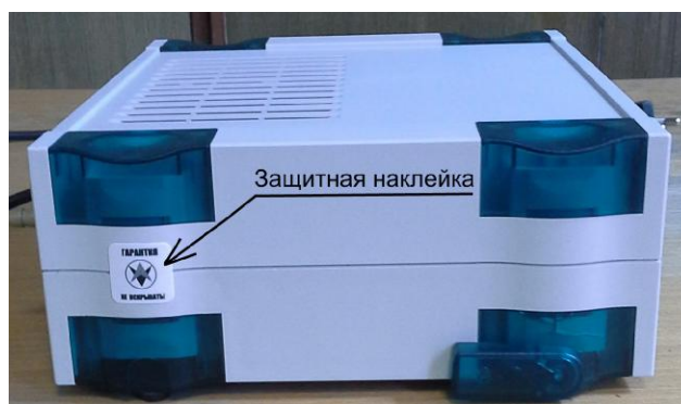
Рисунок 2 - Место нанесения защитной наклейки барометров образцовых переносных БОП-1М
