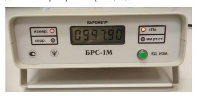
Принцип действия барометра рабочего сетевого основан на использовании вибрационно-частотного преобразователя абсолютного давления, выполненного в виде термочувствительного кварцевого резонатора.
