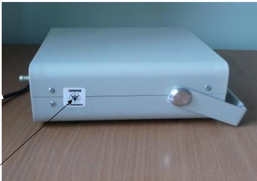
Рисунок 2 - Место нанесения саморазрушающейся наклейки на корпус барометра БРС-1М
