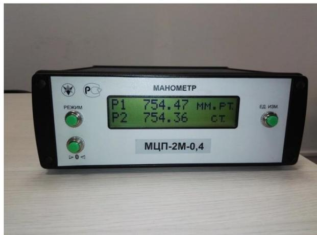
Манометры МЦП-2М имеют два канала давления «P1» и «P2» и содержат два модуля давления.
