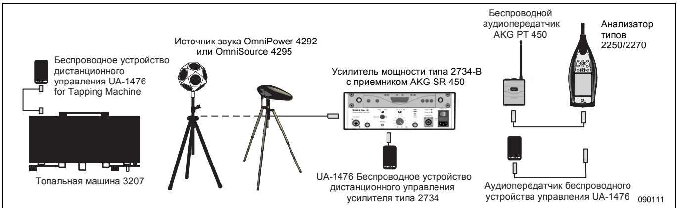
Рисунок 19. Источники звука с дополнительным беспроводным устройством дистанционного управления
