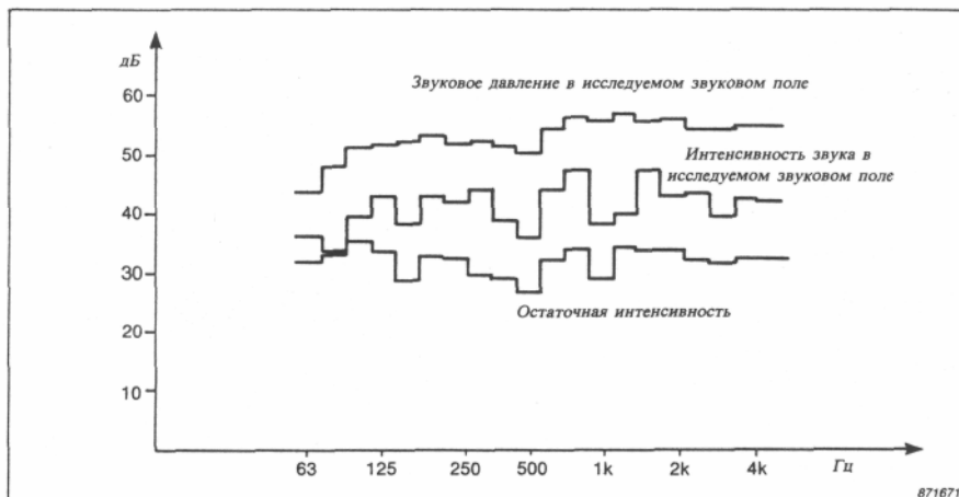
Рис. 8. Спектр интенсивности звука и средний спектр звукового давления, определенные в исследуемом звуковом поле при помощи интенсивметрической аппаратуры. Аппаратура прокалибрована с помощью интенсивметрического калибратора 3541. Спектр остаточной интенсивности определен на основе спектра на рис. 7
