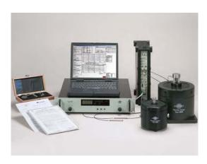
Данная программная система позволяет проводить точную автоматическую калибровку различных акселерометров и датчиков скорости.
