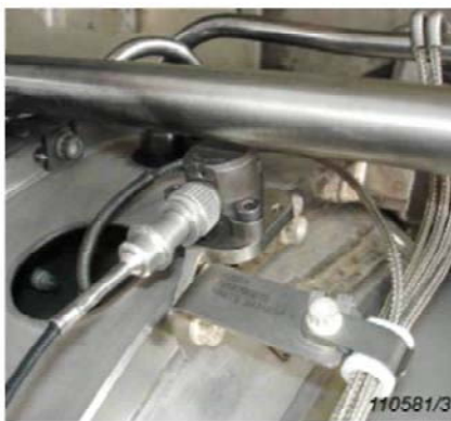
Рис. 3 Зарядовый акселерометр типа 8324, прикрепленный к опоре двигателя
