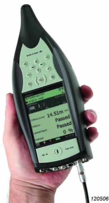
Рис. 1 Портативный анализатор вибрации типа 2250-H-100 - консультант по виброиспытаниям двигателя
