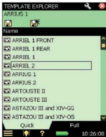
Рис. 4 Слева: Шаблоны двигателя Turbomeca выбираются на цветном сенсорном экране с помощью стилуса. В центре: Поля мета-данных для документирования испытаний. Справа: На дисплее анализатора типа 2250 Н 100 отображается только необходимая информация
