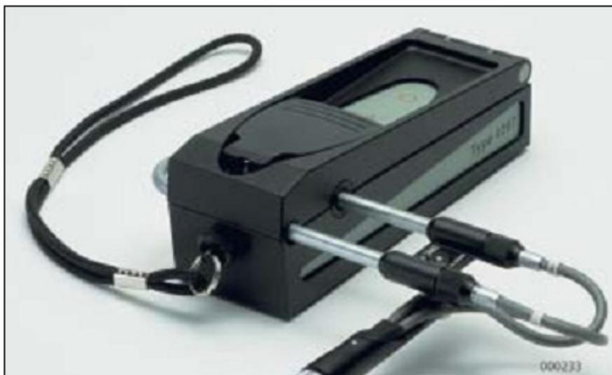
Широкополосный источник звука предусмотрен для измерения спектра показателей остаточного давления. Такие измерения нужны для оценки точности измерений интенсивности звука.
