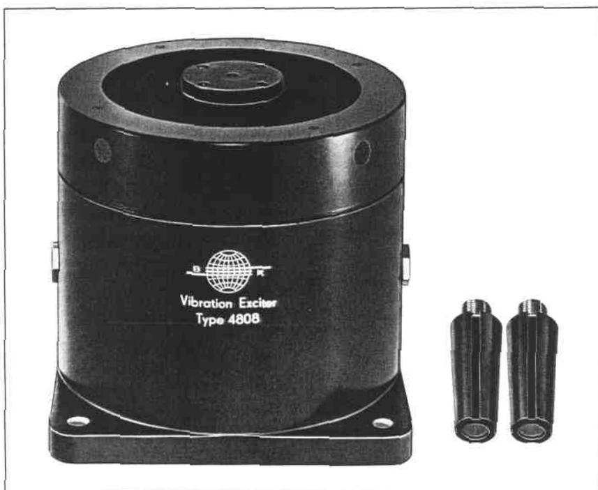
пятью монтажными отверстиями, в которых предусмотрены сменные резьбовые вставки. Эти вставки используются для крепления испытуемого объекта и одновременно служат механическими предохранителями, защищающими подвижной элемент вибростенда от повреждения. В большинстве аварийных случаев внутренние резьбы вставок разрушаются еще до повреждения подвижного элемента.
