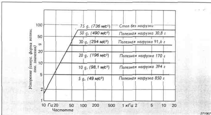
Рис. 2. Эксплуатационная характеристика вибростола 4809 без форсированного воздушного охлаждения
