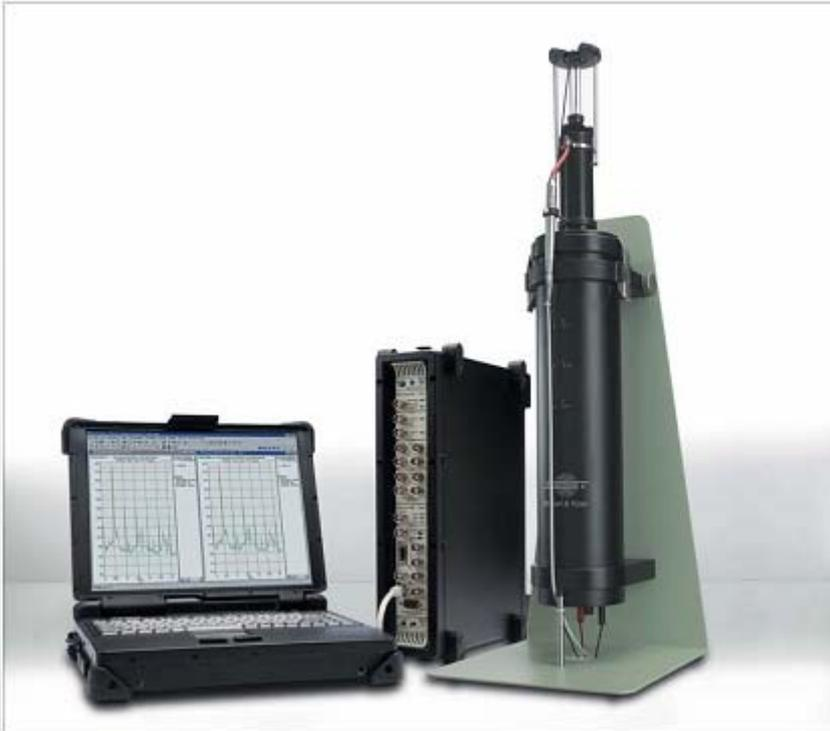
*Эта система измеряет динамическую линейность и гармонические искажения измерительных микрофонов в динамическом диапазоне от 94 до 171 дБ на единственной частоте 500 Гц.*
