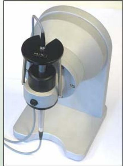
Низкочастотная сравнительная камера типа WB-3570 с микрофонами, предусилителями и резонаторным адаптером.
