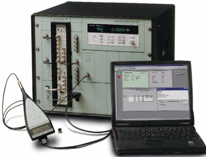
Калибровка измерителей уровня звука выполняется в соответствии с законодательно установленными требованиями. С ростом числа инструментов, требующих калибровки, все более очевидной становится необходимость появления эффективной калибровочной системы.
