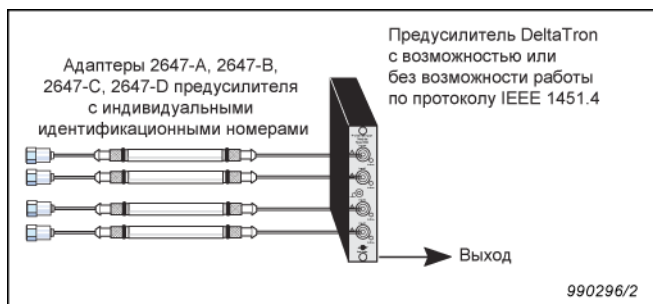
Рисунок 1. Подключение четырех адаптеров типа 2647-A, B, C и D к предусилителю с возможностью или без возможности работы по протоколу IEEE 1451.4.
