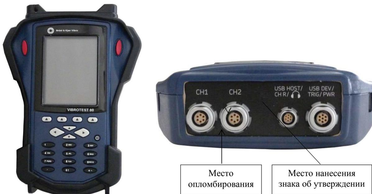
Рисунок 2 - Внешний вид анализаторов вибрации VIBROTEST 80
