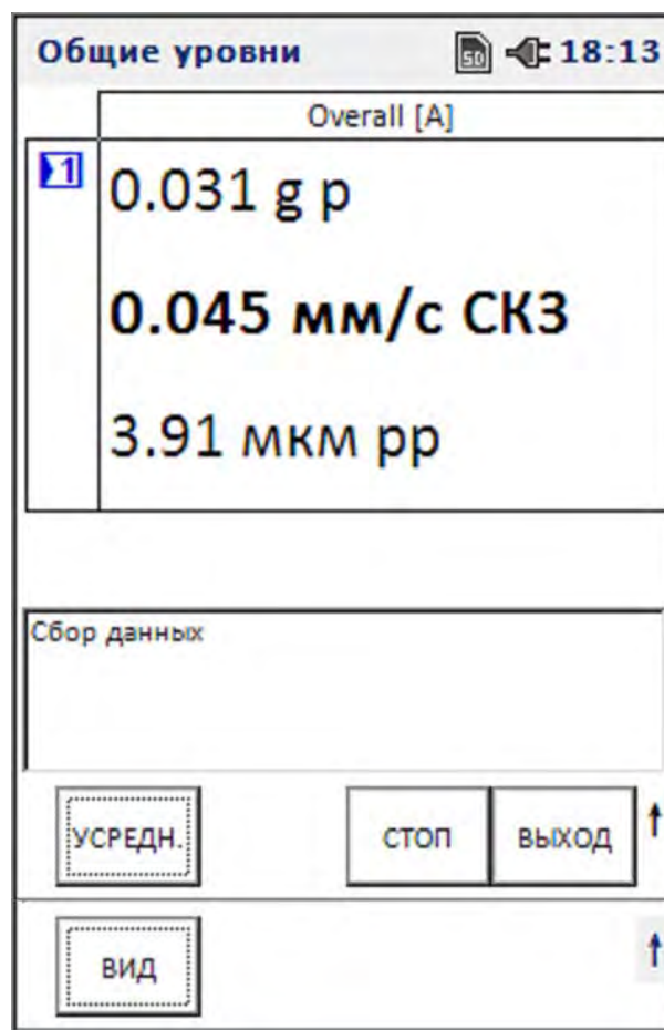
Рис. 15 Измерение суммарной вибрации
