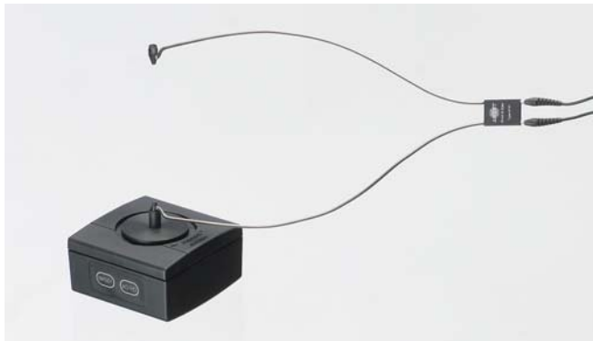
Рис. 3. Калибровка микрофона 4101-A при помощи переходника DP-0978 и звукового калибратора 4231.
