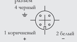
SITRANS P Compact, схема соединения
