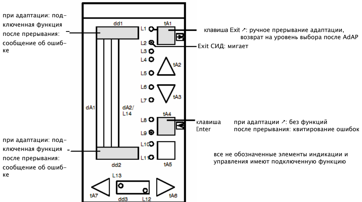
Рис. 3-7 Элементы управления и индикации при адаптации и при прерывании адаптации в ре- жиме параметрирования AdAP
