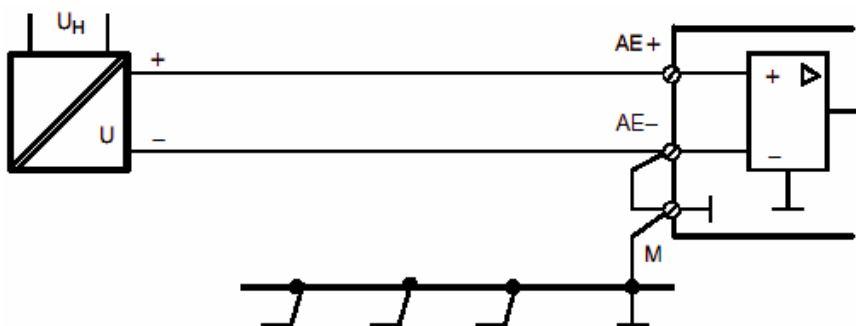
Рис. 2-34 Подключение источника напряжения с разделением потенциалов
