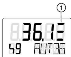
Рис. 9-8. Отображение сообщения с пороговым значением 3 (аварийный сигнал на обслуживание)
