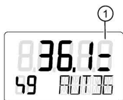
Рис. 9-7. Отображение сообщения с пороговым значением 2 (обслуживание по запросу)
