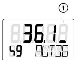
Рис. 9-6. Отображение сообщения с пороговым значением 1 (требуется обслуживание)
