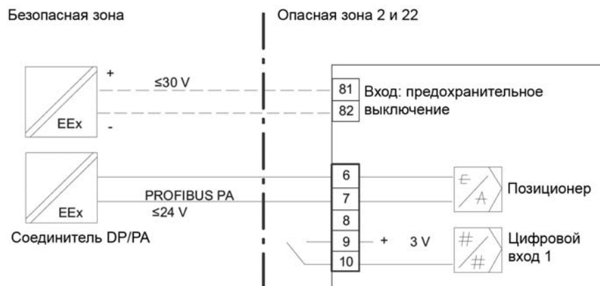
Рисунок 6-18 Подключение стандартного регулятора в версии с типом защиты "n"
