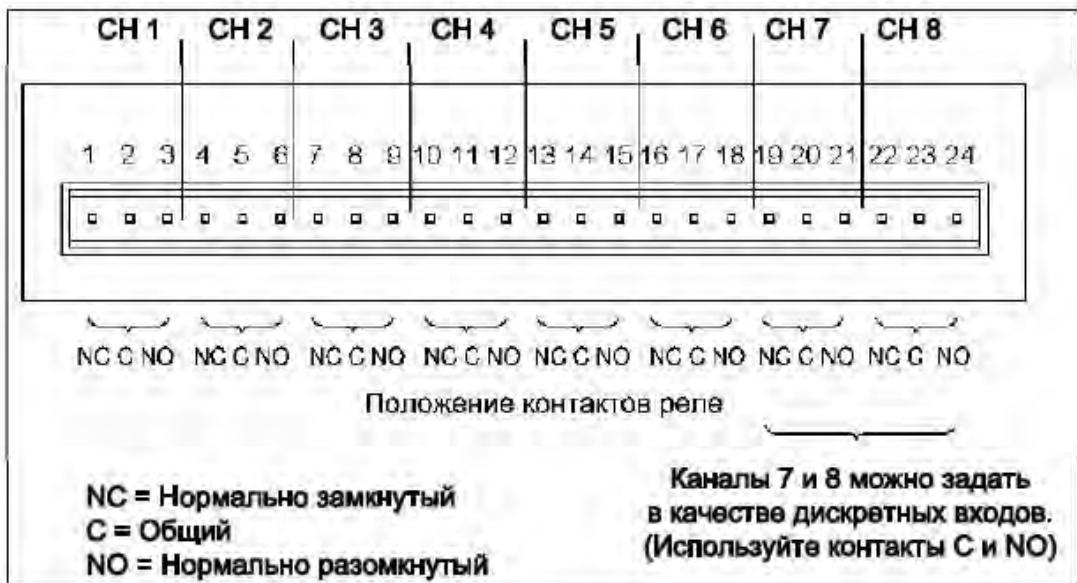
Рисунок 2.8 Детали разъема платы реле сигнализации
