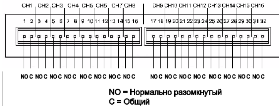
Рисунок 2.9 Детали разъема платы дискретных входов/выходов
