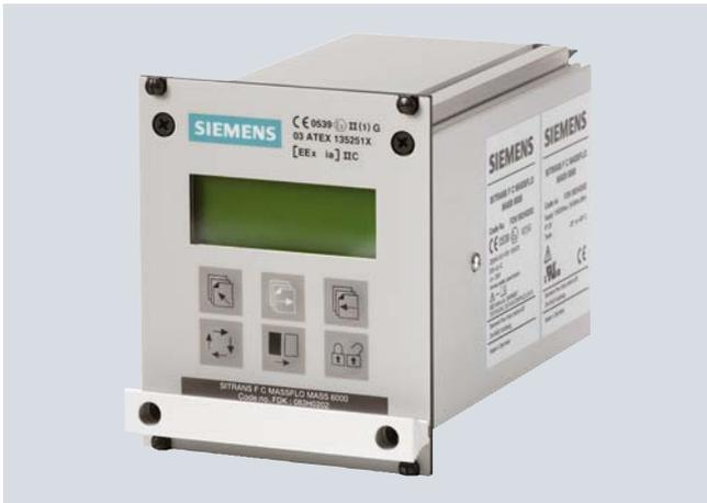
MASS 6000 основан на последних достижениях в области технологии обработки цифрового сигнала — спроектированный для высокой производительности, быстрого отклика на изменения потока, быстрых режимов дозирования, высокой устойчивости к шумам процесса, легкой установки, ввода в эксплуатацию и поддержки. Преобразователь MASS 6000 дает возможность производить достоверные многопараметрические измерения: Массовый расход, объемный расход, плотность, температуру и фракции.
