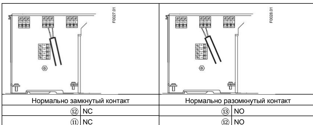
Пример подключения для канала 3 — подключение реле
