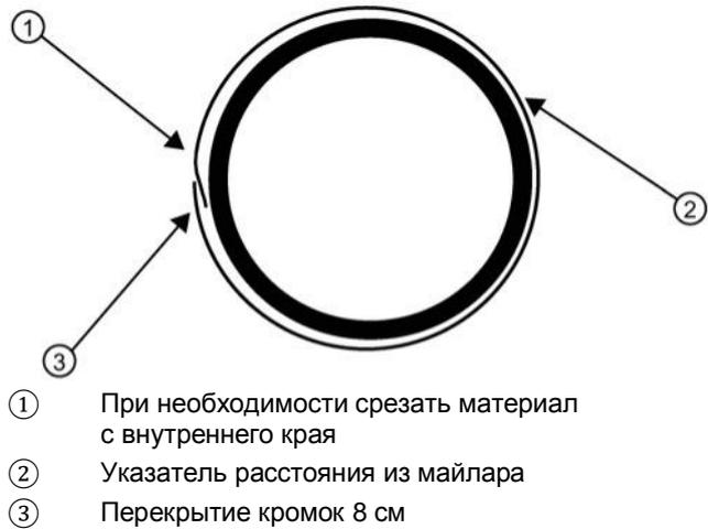
Рис. В-3. Наложение указателя расстояния из майлара на трубу (вид с торца)
