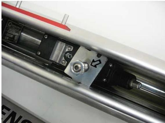
Рис. В-41. Винт зажимной пластины датчика и стопорная гайка
