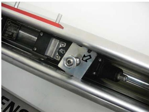
Рис. В-48. Сборка зажимной пластины датчика и стопорная гайка
