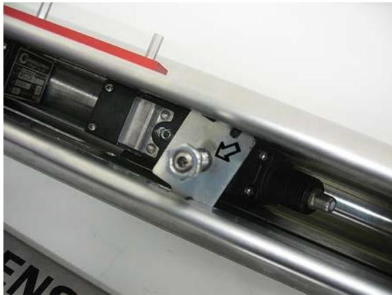
Рис. В-36. Винт зажимной пластины датчика и стопорная гайка
