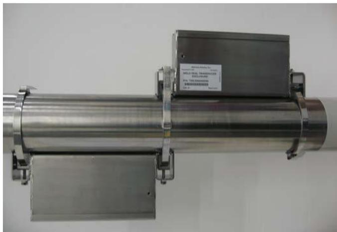
Рис. В-45. Монтаж высокоточного датчика для режима измерения прямым лучом с двойным корпусом (для минимального индексного расстояния)
