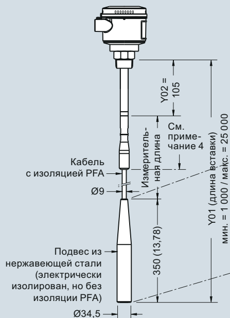
Модификация с кабелем, с изоляцией 3) Резьбовое соединение (7ML5673)
