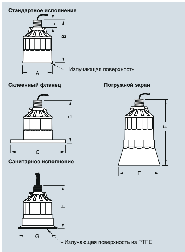
Ультразвуковой преобразователь XPS, размеры в мм
