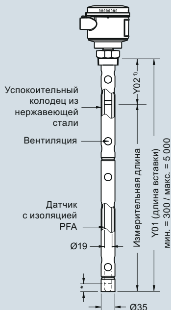
Резьбовое соединение (7ML5671)
