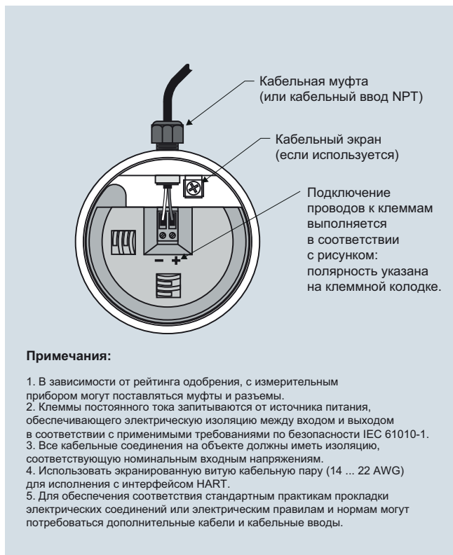
SITRANS LR560, схема соединений
