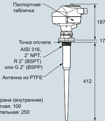
Стержневая антенна из PTFE, с резьбой
