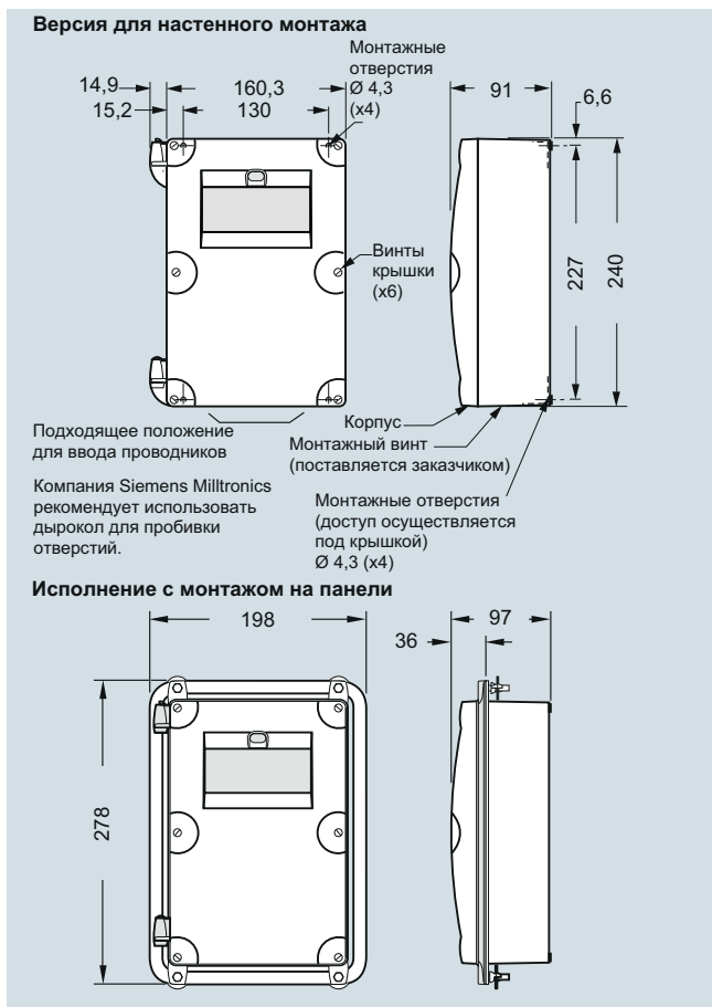
MultiRanger, размеры в мм
