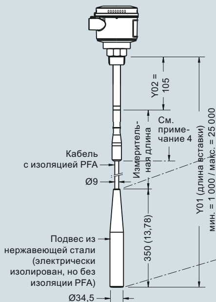
Модификация с кабелем, с изоляцией 3) Резьбовое соединение (7ML5673)
