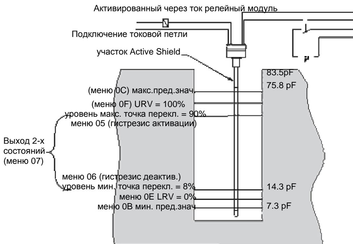
Установки прибора: (перед вводом в эксплуатацию прибора сначала вернуть параметры на заводскую установку)
