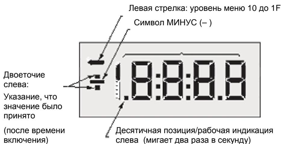
Информация остается длительное время на ЖКД, даже без обновления (к примеру, при отключении питания). При работающем приборе непрерывно мигает рабочая индикация. Остановка мигания рабочей индикации означает, что прибор приостановил работу.
