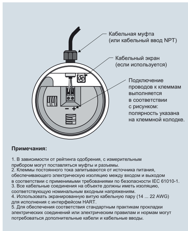
SITRANS LR560, схема соединений
