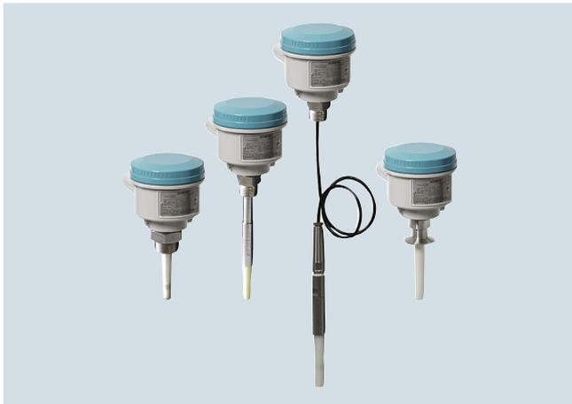
Pointek CLS200 (стандартное исполнение) — универсальный емкостной сигнализатор с инверсной частотной модуляцией: различные варианты (стержень/кабель) и конфигурируемый выход; идеально подходит для жидкостей, сухих веществ, взвесей, пены, а также для определения раздела фаз.
