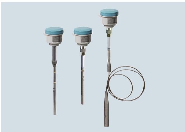
Pointek CLS300 — емкостной сигнализатор уровня с инверсной частотной модуляцией — различные варианты (стержень/кабель) и конфигурируемый выход. Идеально подходит для работы с жидкостями, сухими веществами, взвесями, пеной и разделительным слоем в сложных условиях — при высоком давлении и температуре.
