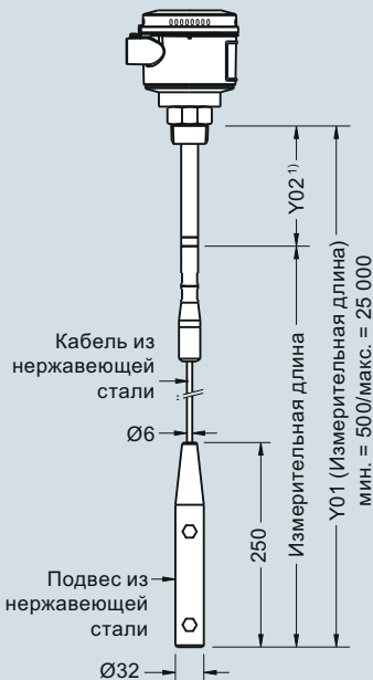
Модификация с кабелем, без изоляции Резьбовое (7ML5651 и 7ML5661)
