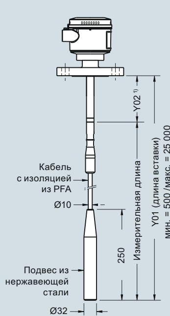
Модификация с кабелем, с изоляцией Сварной фланец (7ML5651 и 7ML5661)
