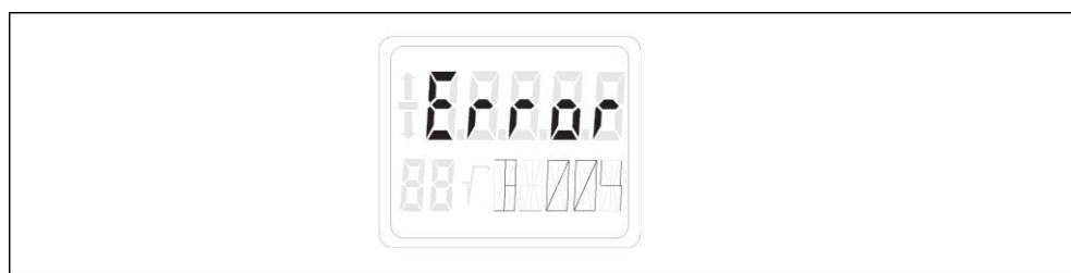
Рис. 18 Пример сообщения об ошибке «Сбой датчика»
