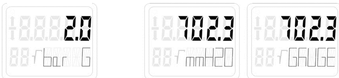
Рис. 7-13 Пример дополнения с избыточным давлением (GAUGE)
