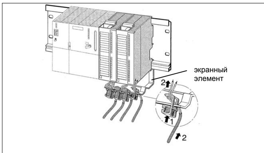
Рис. 2-1 Экранирующий элемент
