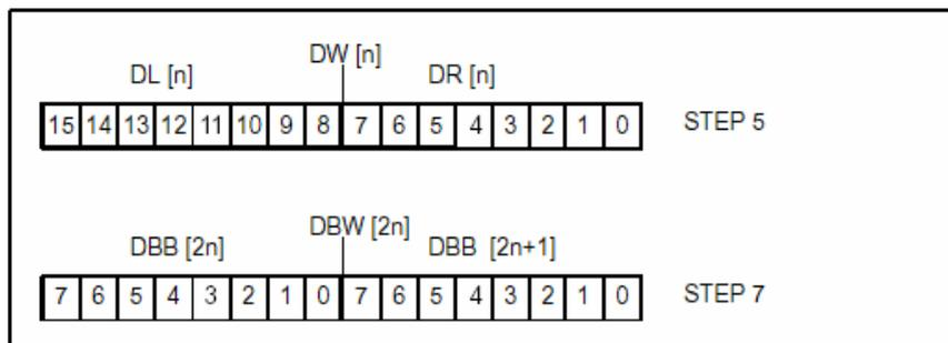
Рис. 10-1 Сравнение адресации данных у STEP 5 и STEP 7
