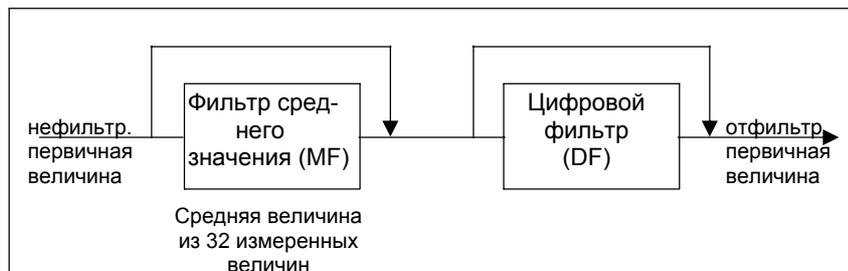
Рис. 3-1 Принцип фильтрации SIWAREX U
