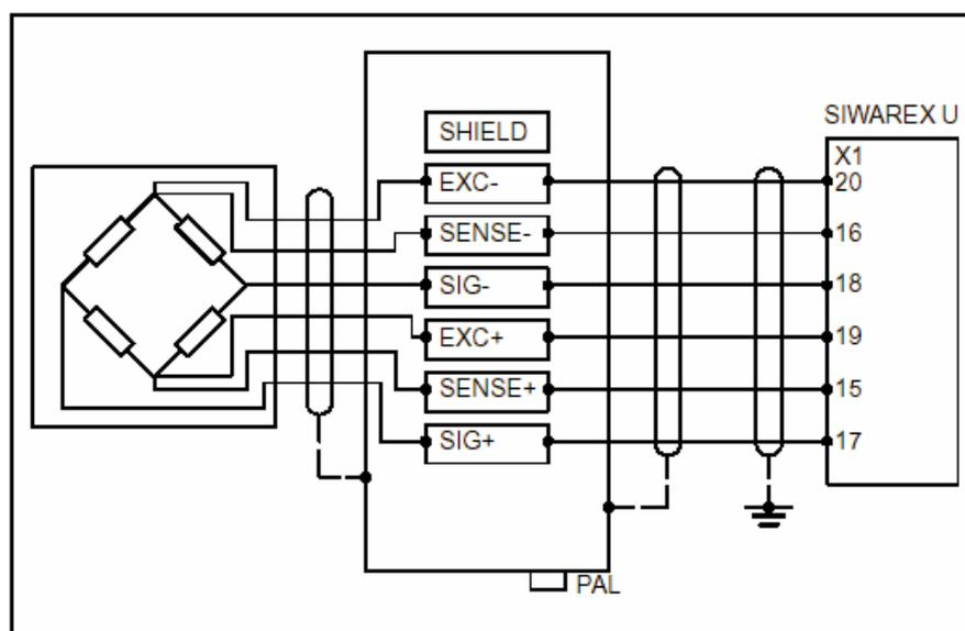
Рис. 2-4 Подсоединение весоизмерительных ячеек по 6-ти проводной схеме (пример: подсоединение к каналу 1)
