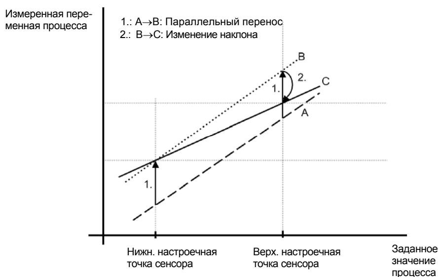
Рис. 13 Подстройка сенсора
