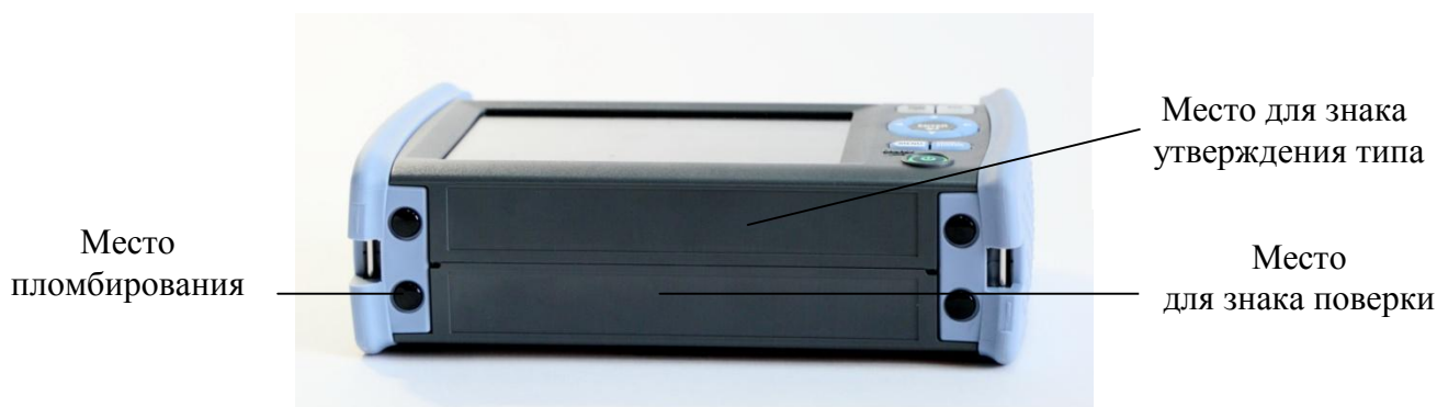
Рисунок 2 – Задняя панель рефлектометров со схемой пломбировки от несанкционированного доступа и местом нанесения знака утверждения типа и поверки
