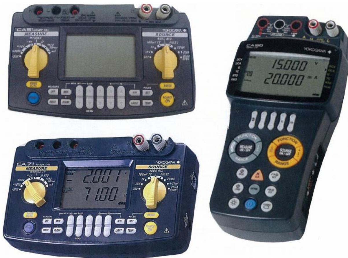
Рисунок 3 - Общий вид калибраторов CA51, CA71, CA150
