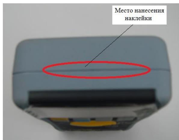
Рисунок 5 - Схема пломбирования калибраторов CA51, CA71, CA150, CA450
